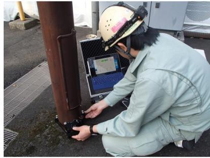
センサーを動かし測定値を表示ユニットで確認
