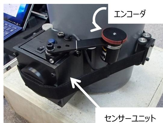
ベルトで巻きつけたセンサー部を手動で動作させる。ローラーがついておりなめらかな動作が可能
