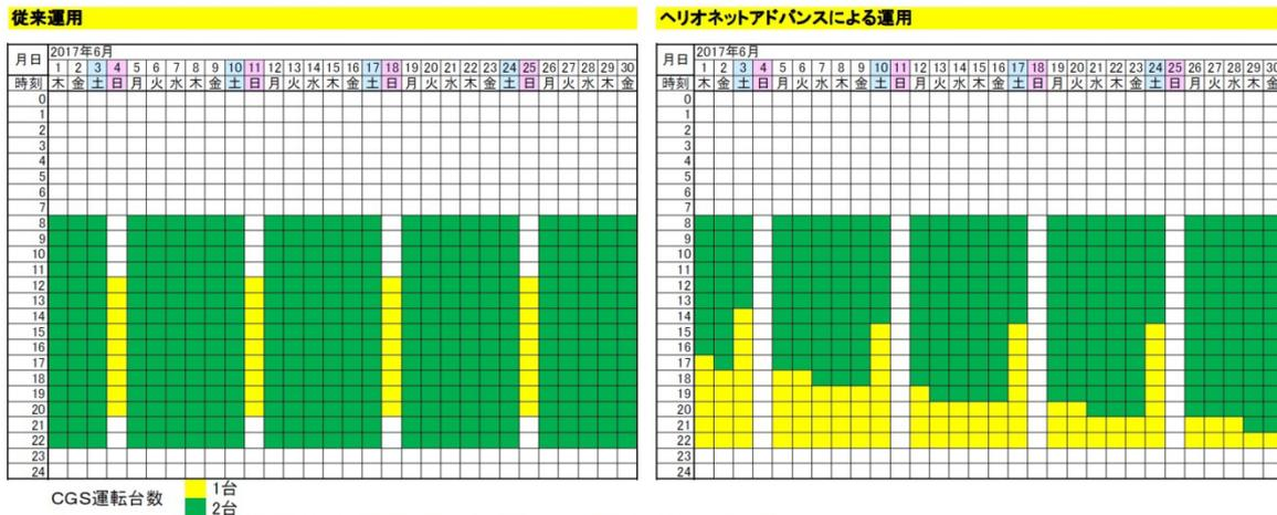
従来のCGSの運用は年間を通じて予め設定された画一的なスケジュール運転が一般的でしたが本システムでは、CGSや冷凍機を最適に台数制御する運用となり、年間で最大1割程度の省エネが可能となります。
