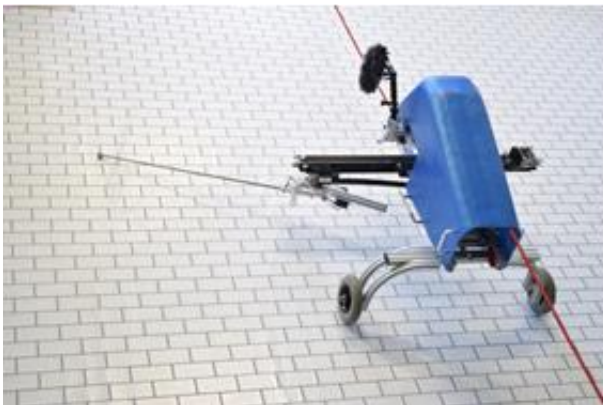
新開発ロボット「ブルークローラー」による 壁面タイルの検査の様子
