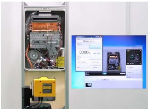
③ 検査画面給湯器のあらかじめ設定した検査場所をレーザーでスキャン
