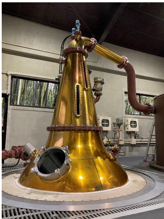
サントリー山崎蒸溜所内パイロットディスティラリー蒸溜釜
