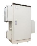
本製品は、都市ガス仕様の小型防災用発電設備(出力 3kVA)で、停電時も燃料切れの心配な く電気を使用することができます。また、新開発のマルチ燃料対応ミキサーを搭載しており、燃料バルブ操 作のみで LP ガスに切り替えることが可能です。
